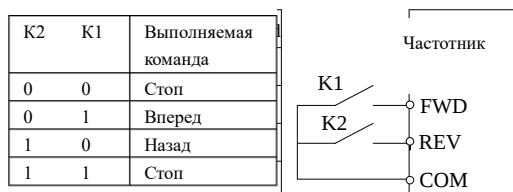
Рис.6-13 Двухпроводной режим управления 1
