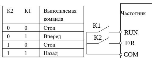
Рис. 6-14 Двухпроводной режим управления 2
