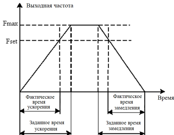
Рис. 6-2 Схема времени ускорения/замедления
